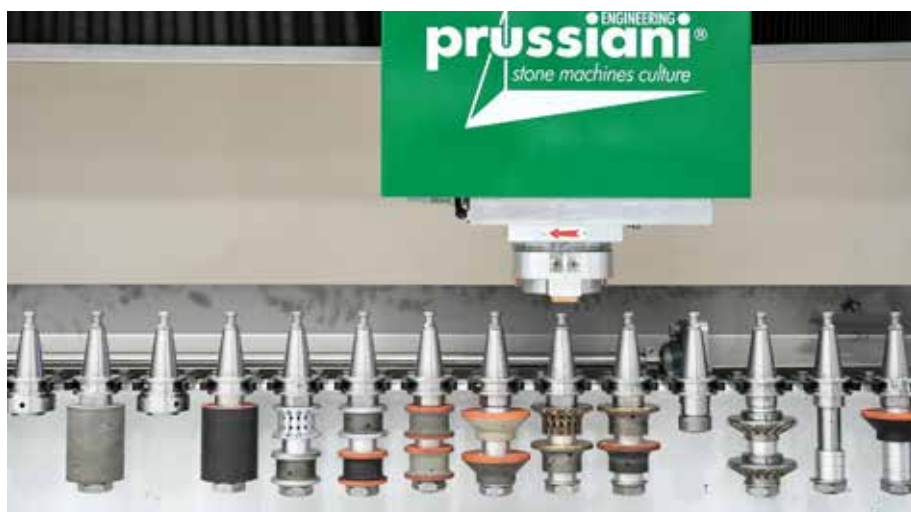
Stopky držáků, nástrojů, které mohou podporovat dva profilovací nástroje.
