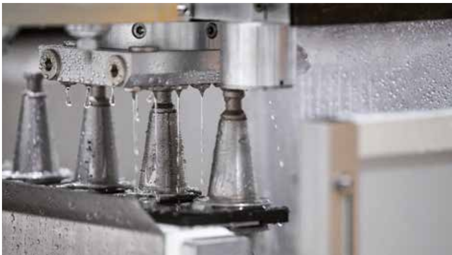
Výměník nástrojů je prakticky bezúdržbový. Tělo upínačů je vyrobeno ze speciální nerezové oceli.
